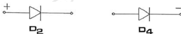
Figura 2-80 Polarização de D_2 e D_4 no semiciclo positivo da tensão de entrada
