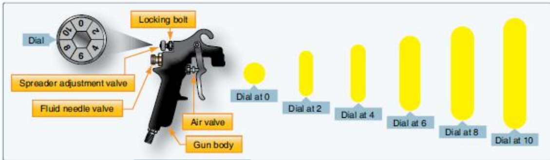
Figura 4-1 Formato do jato de tinta nas diferentes regulagens do dial.
