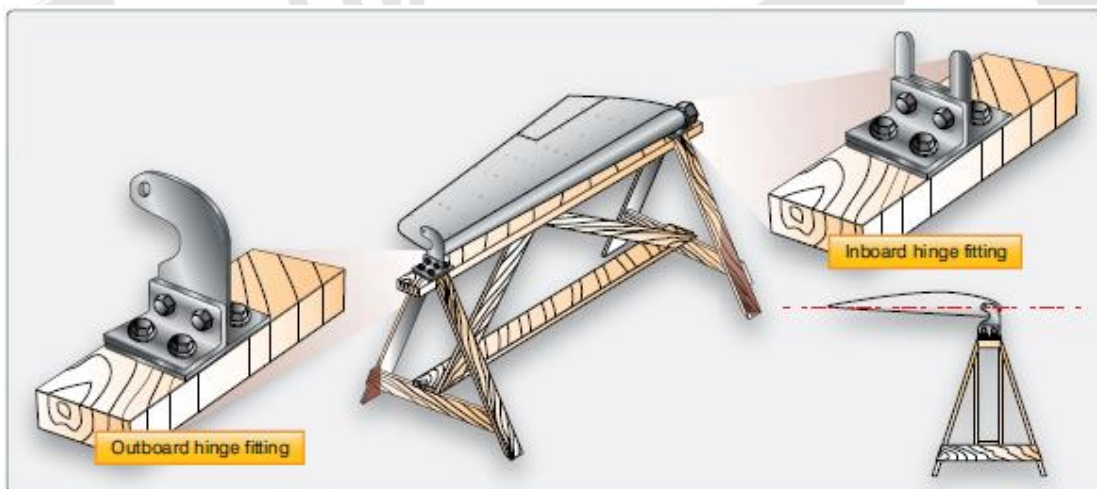
Fonte: FAA - Mechanic Training Handbook-Airframe Figura 2-23 Gabarito de balanceamento
