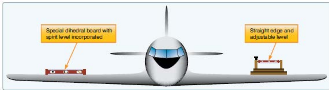
Figura 2-12 Inspeção do diedro.
