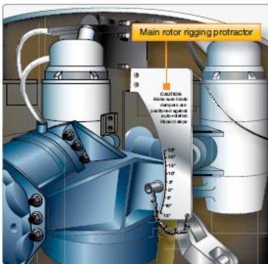
Figura 2-17 Um típico transferidor de ajuste.
