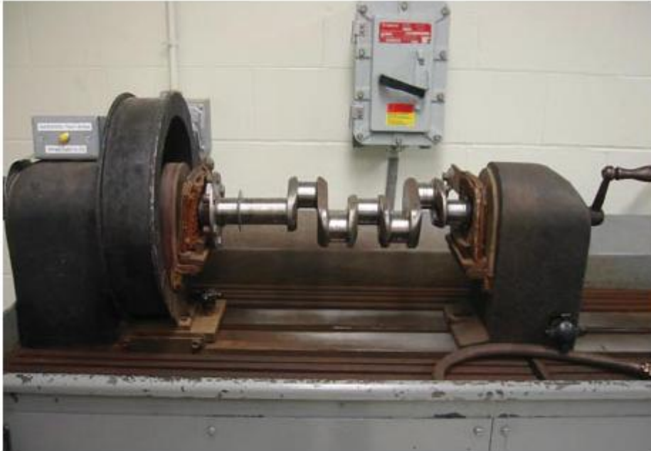
Figura 10-4 Magnetização circular de um eixo manivela.
