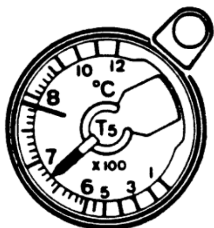
Figura 3-72 Sistema de Indicação de Temperatura Interturbinas (T5) do Motor (Esquemático)
