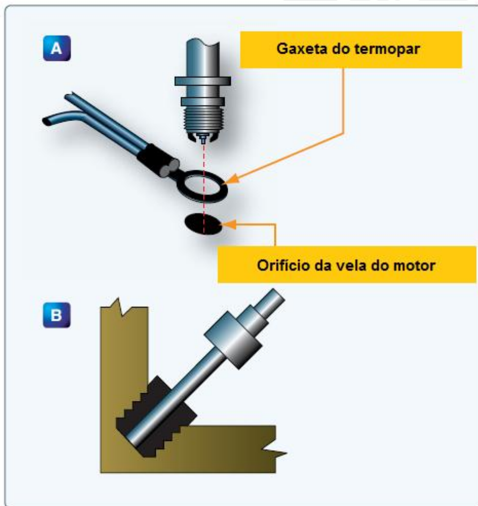
Figura 3-66 Termopares: A - tipo gaxeta; B - tipo baioneta
