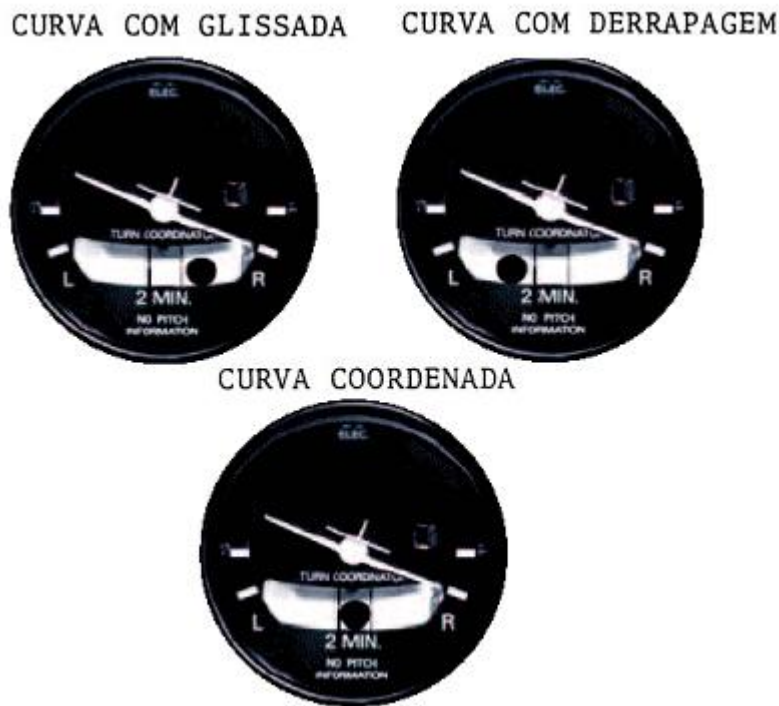
Figura 2-51 Indicações de um inclinômetro em situações distintas de voo.
