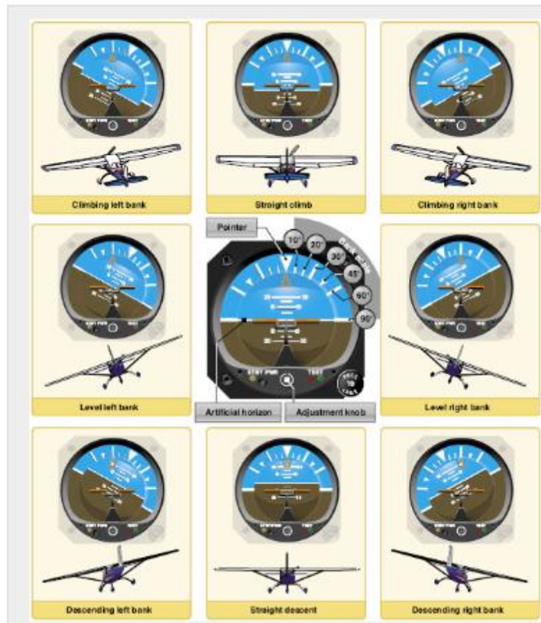
Figura 2-22 Posição vertical do giroscópio
