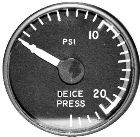
Figura 4-79 Indicação da pressão do degelador.
