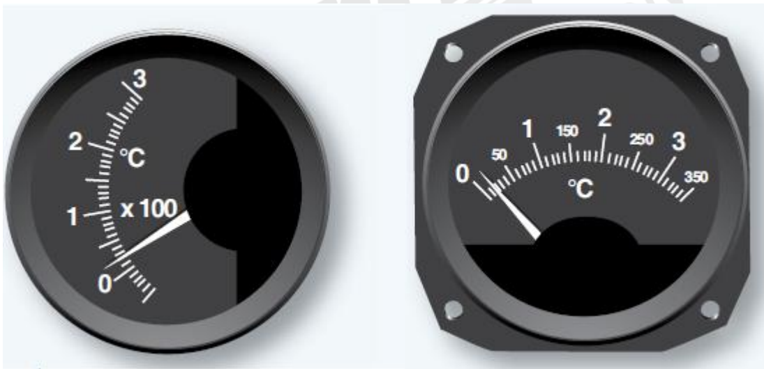
Figura 3-67 Indicadores de temperatura de termopares
