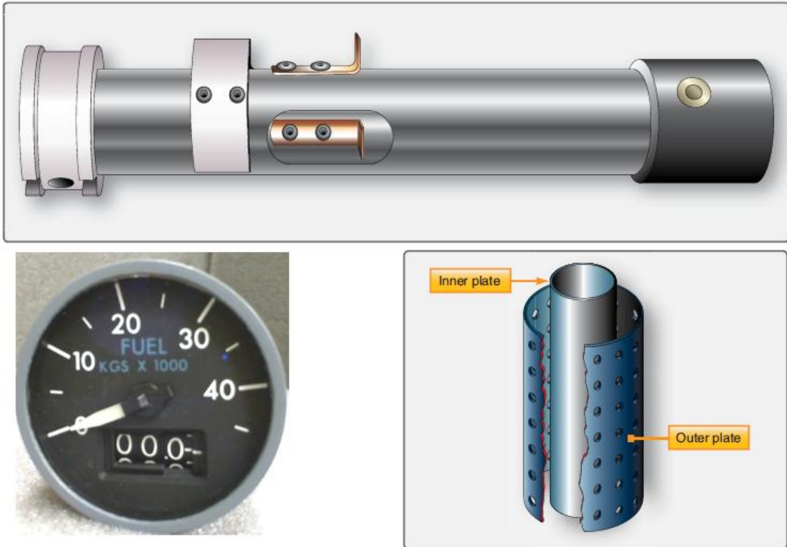
Figura 4-70 Indicador e sonda de um sistema tipo capacitor
