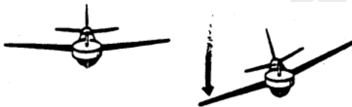
Figura 2-21 Posição vertical do eixo do rotor independente da posição da aeronave
