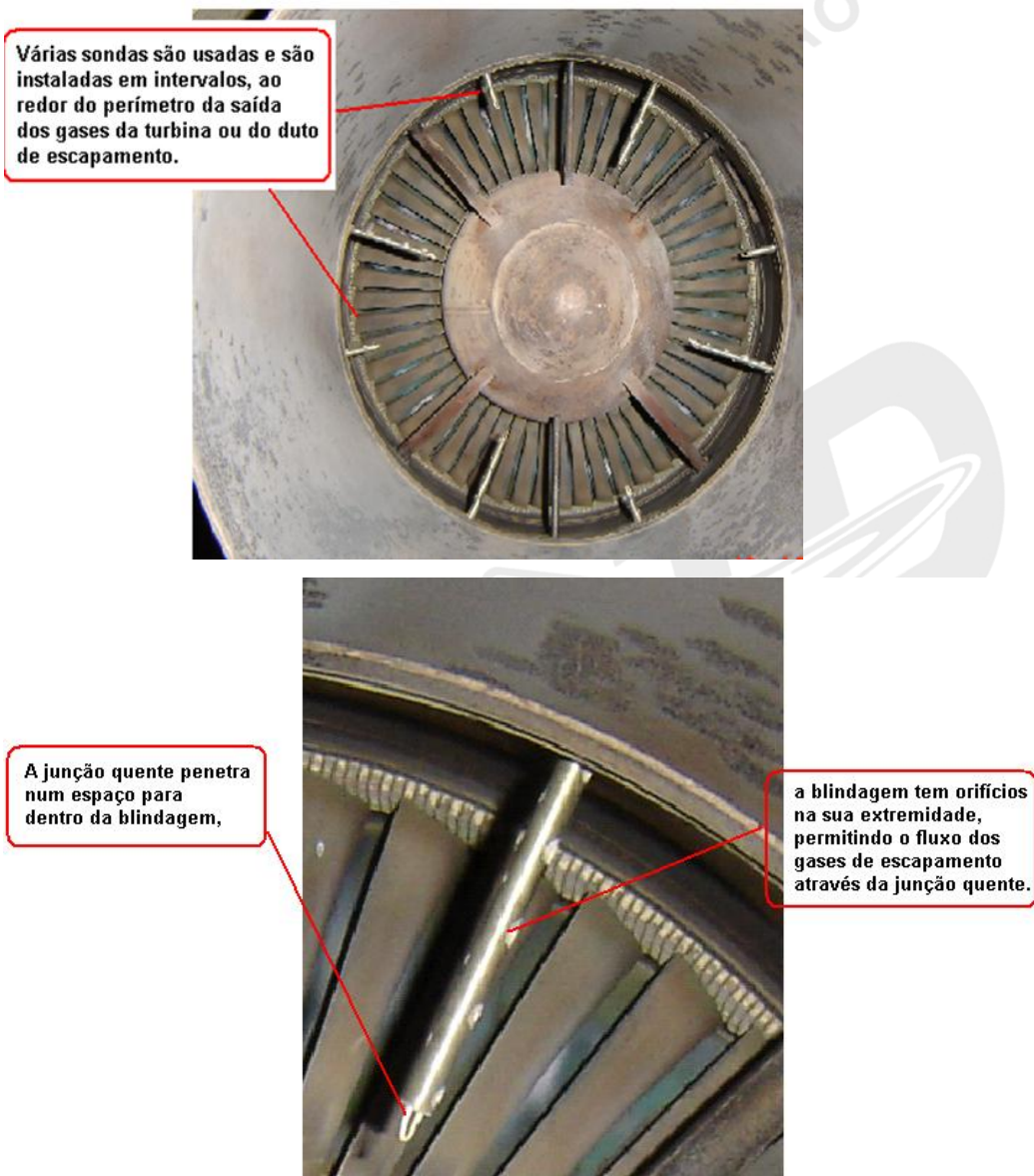
Figura 3-68 Típico sistema de indicação de temperatura dos gases do escapamento
