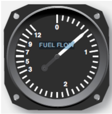
Figura 4-26 Típico indicador de fluxo de combustível
