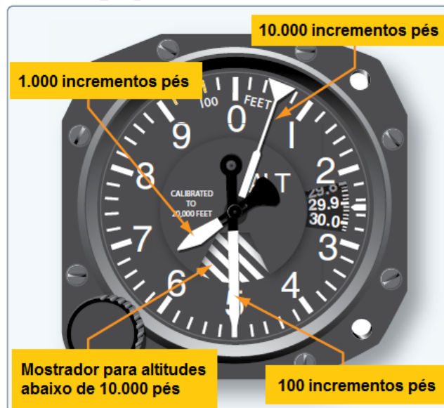
Figura 1-40 Altímetro primitivo de três ponteiros
