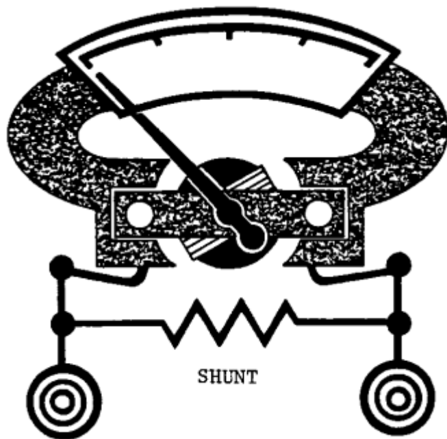
Figura 4-48 Mecanismo de um amperímetro
