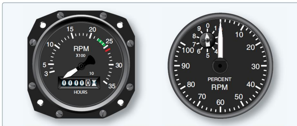
Figura 4-28 Tipos de tacômetros
