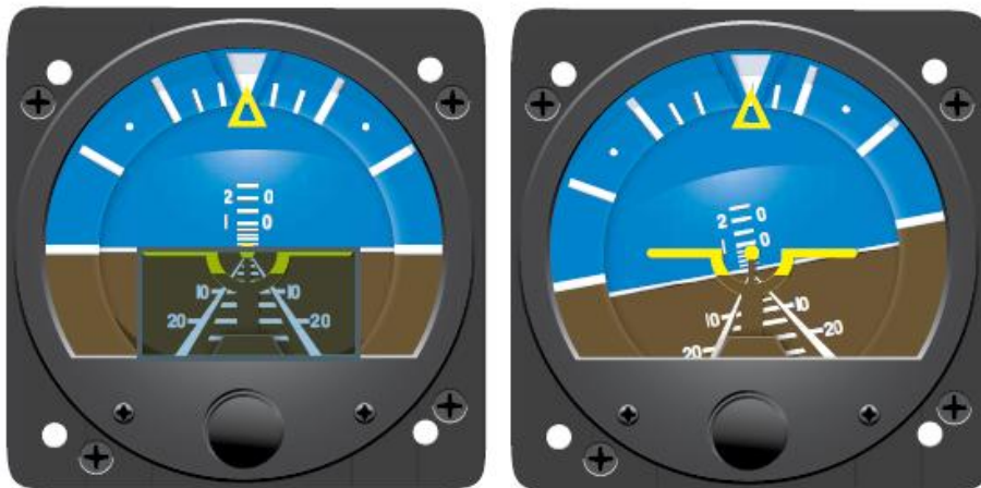
Figura 2-15 Típico horizonte artificial que utiliza giroscópios de atitude acionados por sucção
