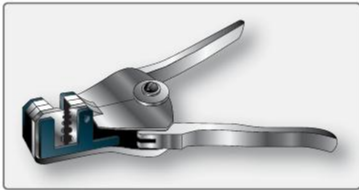
Figura 4-104 Desencapador manual de fios.
