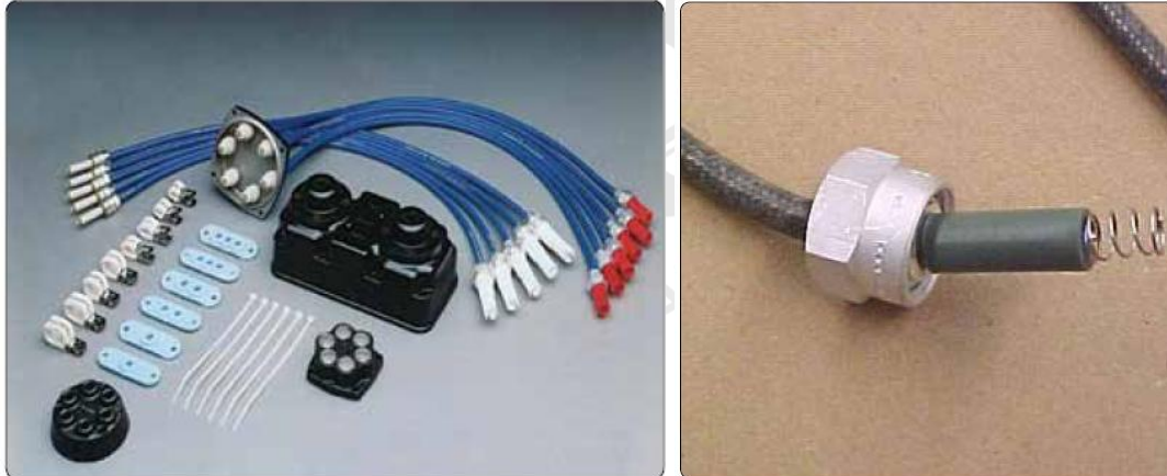
Figura 4-10 Cablagem de ignição de alta tensão e plug para a vela.
