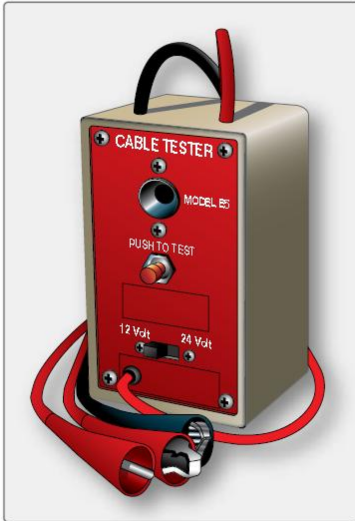
Figura 4-70 Teste de cablagem de ignição de alta tensão.
