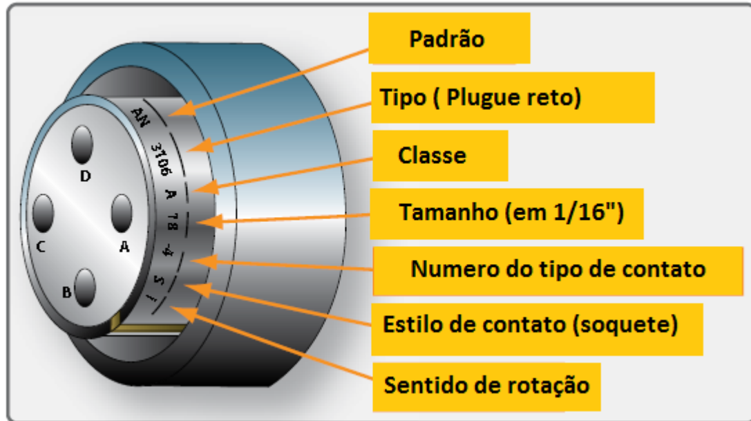
Figura 4-119 Codificação do conector AN.
