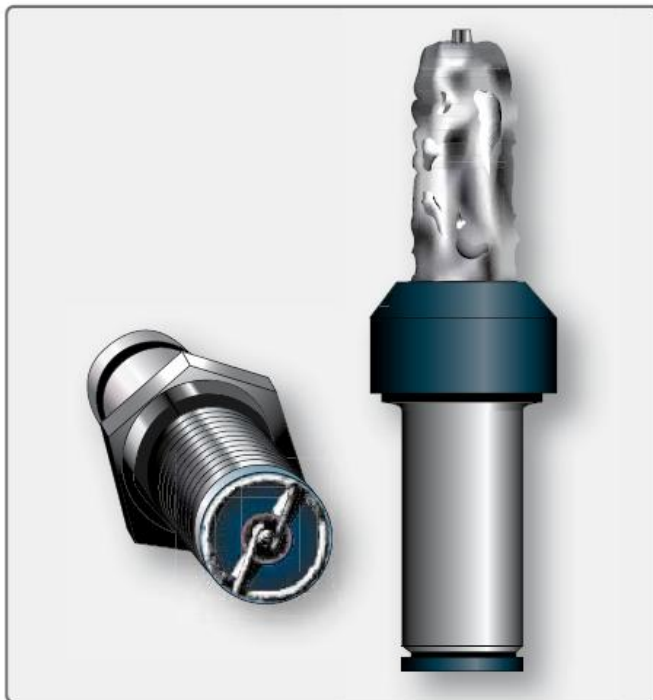
Figura 4-53 Velas com depósito de chumbo.
