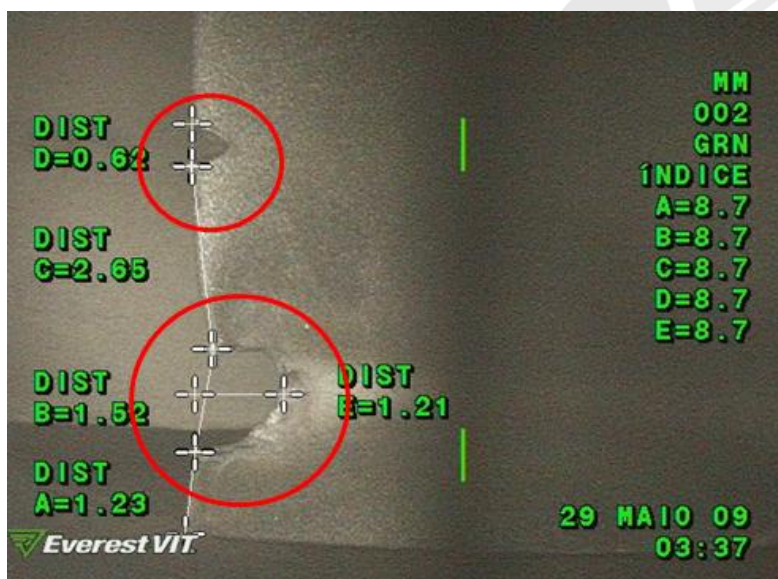
Figura: Parte interna de um motor a reação, palhetas das turbinas.
